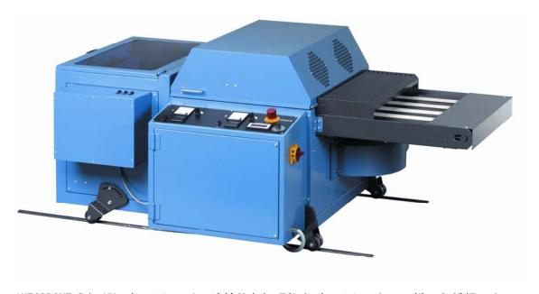
AKTIPRINT P/e UV ドライヤーは、連続的な処理能力ドライヤーとして様々な種類のオフセット印刷機と共に使用することができます。この装置は、高い速度で UV インキや UV ニスを照射することを目的として製造されました。AKTIPRINT P/e UV ドライヤーは既存のオフセット印刷機のラインに装着することができます。設置時には、既存の印刷機ラインについての詳細をお知らせ頂くことになります。この装置は、2 つあるいは 3 つの UV ランプ(Hg および最大 120W/cm、各々)が利用可能です。また、30 - 100%まで出力を調節することができるように、ECG(電子安定器)を装備しています。
